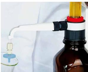
Filtración estéril de medios directamente del frasco con la cánula de dosificación con conector de Luer-Lock
