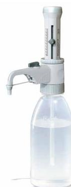
Para la dosificación de ácido fluorhídrico (HF) recomendamos el dosificador acoplable a frasco Dispensette® S Trace Analysis con válvula de resorte de platino-iridio. Encontrará más informaciones en [www.brand.de](http://www.brand.de)
